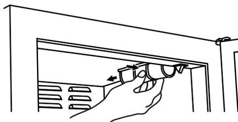
3. Remplacer l'ampoule par une ampoule pour appareils ménagers de même puissance.
