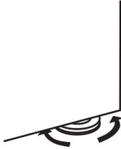
4. Ouvrir la porte de nouveau et vérifier pour s'assurer qu'elle ferme comme vous le désirez. Sinon, incliner le réfrigérateur un peu plus vers l'arrière en tournant les deux vis de nivellement vers la droite. Plusieurs tours peuvent être nécessaires et vous devez tourner les deux vis de nivellement de façon égale.
